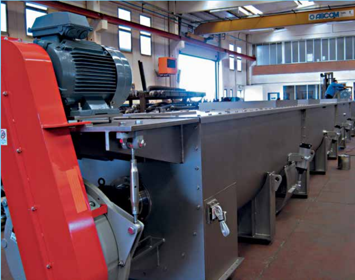
Coclee per trasporto zucchero umido diam. 1000 LC= 18 mt con doppia motorizzazione 37+45 Kw
